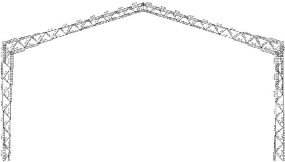
Рис. 6. Результати чисельного розрахунку рамної конструкції за програмою SCAD: а – схема рами; б – епюра поздовжніх сил
