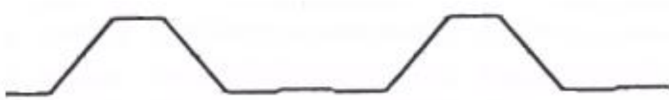
а) трапецієвидні гофри без підсилення складових частин
