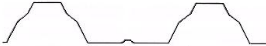
б) трапецієвидні гофри з підсиленням стінки і нижньої полиці
