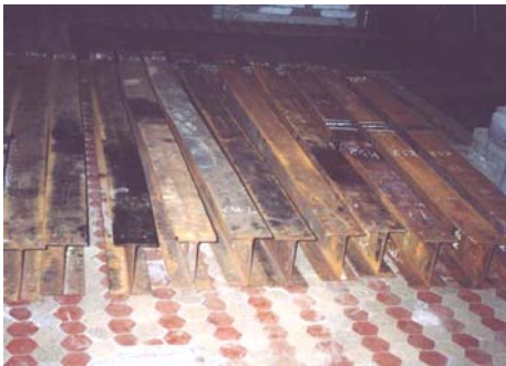
Рис. 3. Общий вид сварных образцов [7] после испытаний
