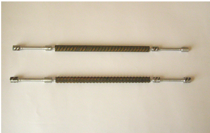
Рис. 1. Виготовлення експериментальних зразків з арматури періодичного профілю
