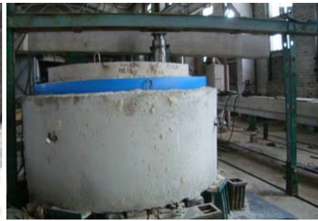
Рис. 4. Общий вид испытаный колодца КЛ-1000 сосредоточенной нагрузкой
