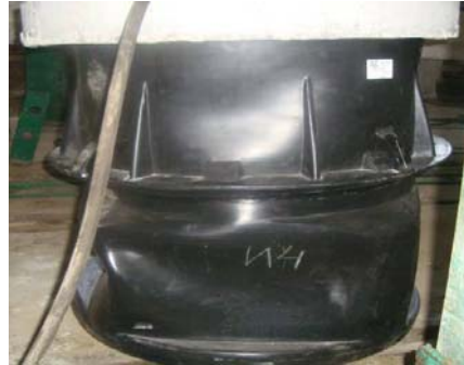
Рис. 6. Внешний вид колодца КЛ-660 после испытания в лабораторных условиях
