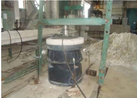
Рис. 5. Общий вид испытанной колодца КЛ-660 в лабораторных условиях
