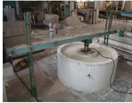
Рис. 2. Общий вид испытаный колодца КЛ-660, видны индикаторы часового типа
