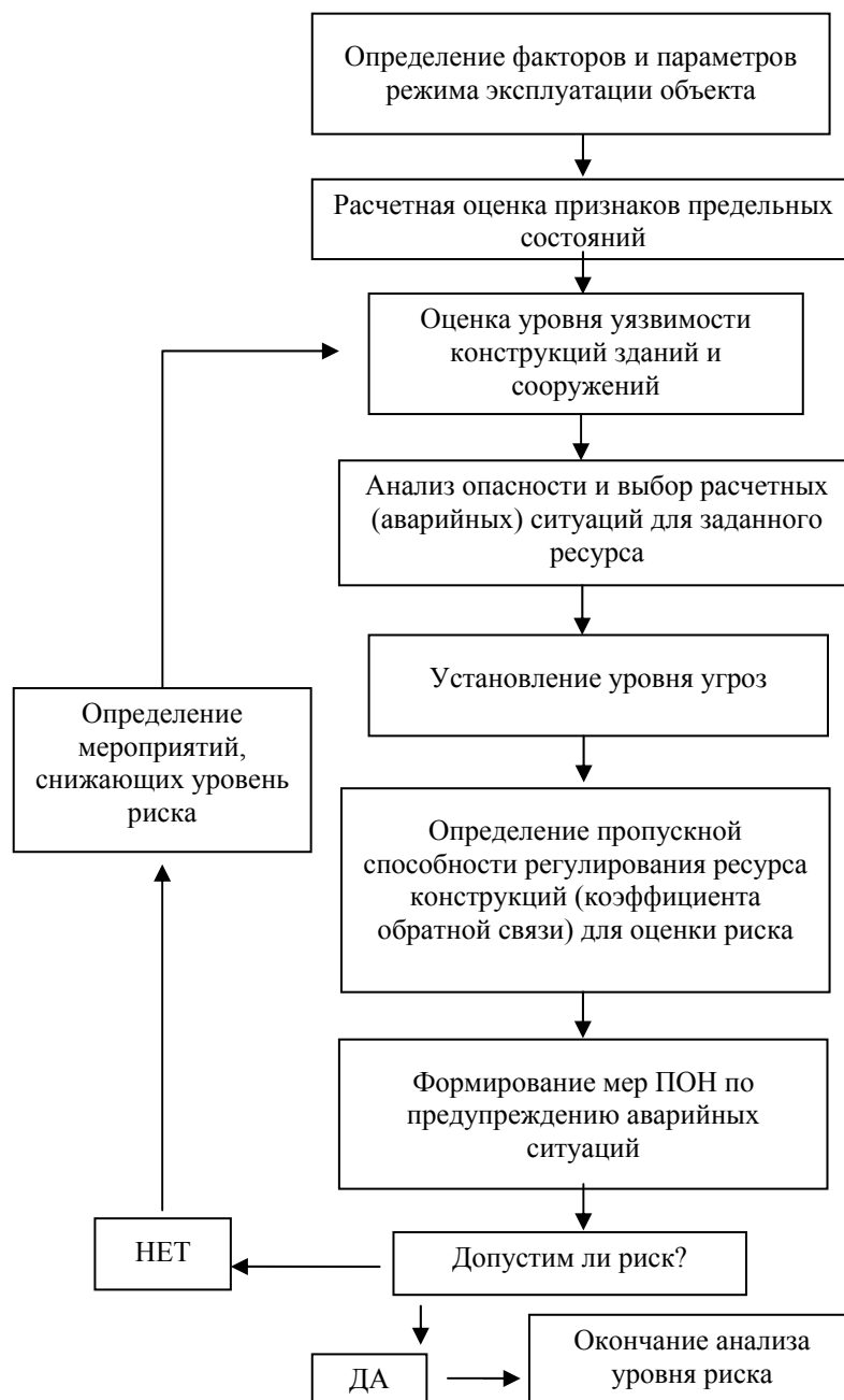
Рис.2. Схема управления уровнем риска
