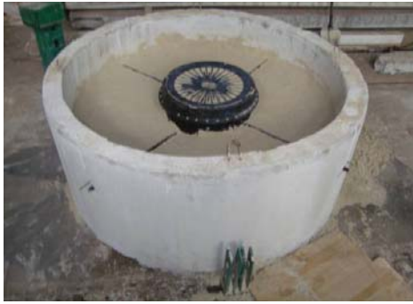
Рис. 1. Общий вид колодца КЛ-660 перед испытанием, видны трубки измерительного приспособления
