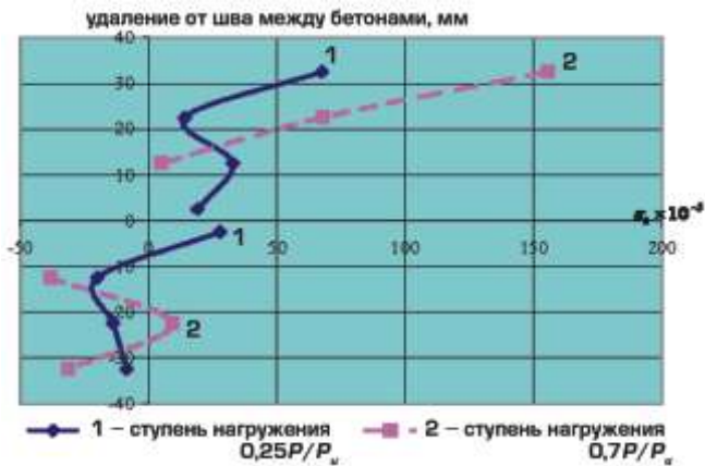
Рис. 5. Графики зависимости расстояния от шва от деформаций бетона \epsilon_b в слоях, прилегающих к шву в экспериментальной балке-стенке ШБС30-30 третьей серии
