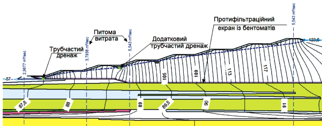
Рис. 6. Положення кривої депресії, питомі витрати та ізолінії рівних напорів при додатковому дренажі
