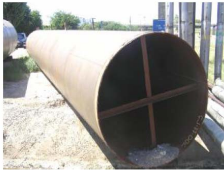
Рис. 2. Отправочный элемент трубы
