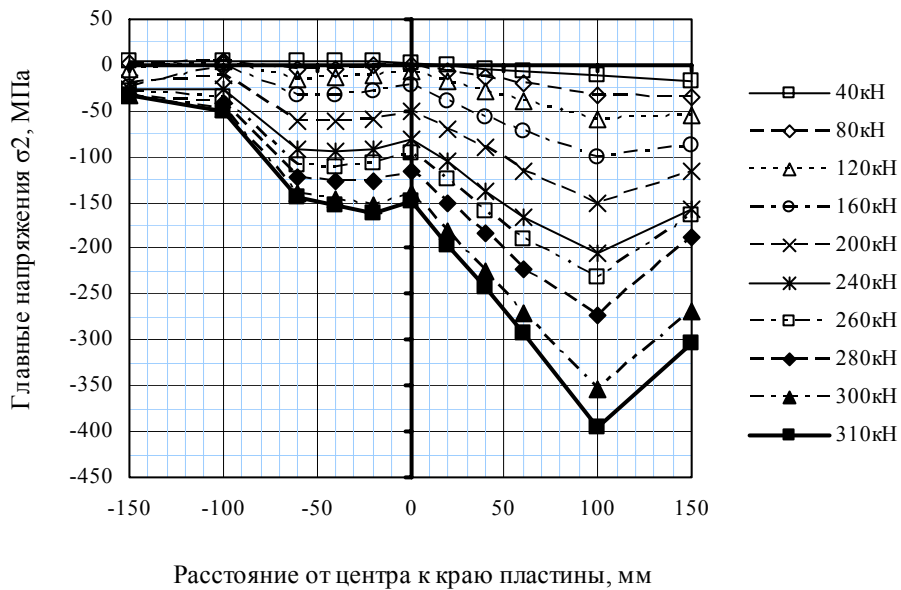
Рис. 6. Распределение главных напряжений \sigma_{1,2} ( \sigma_1 > \sigma_2 ) в пластине с температурой нагрева в центре 1000^\circ\text{C}
