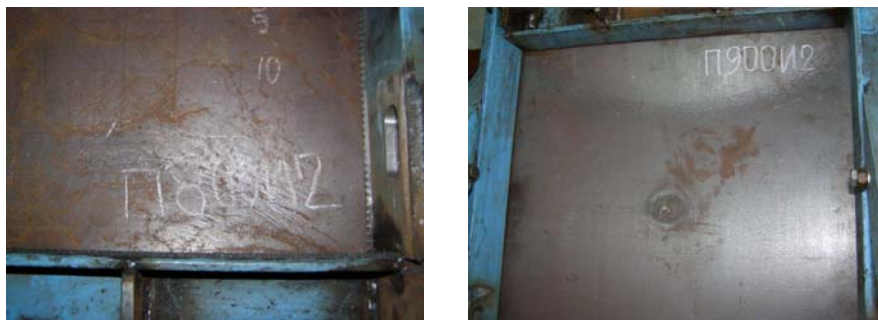
Рис. 2. Линии сдвиговых деформаций (линии Чернова–Людерса) в некоторых пластинах после испытаний
