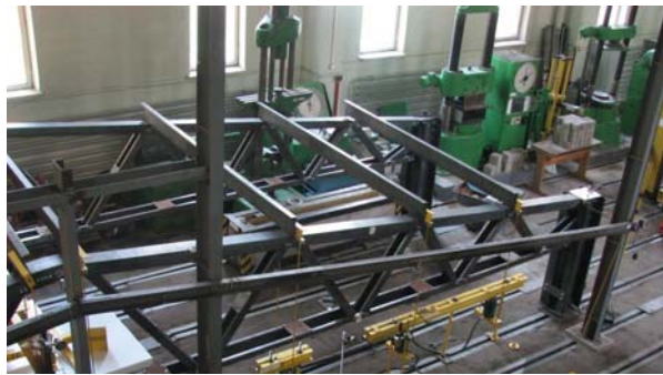
Рис. 7. Блок експериментальних конструкцій, з'єднаних між собою прогонами
