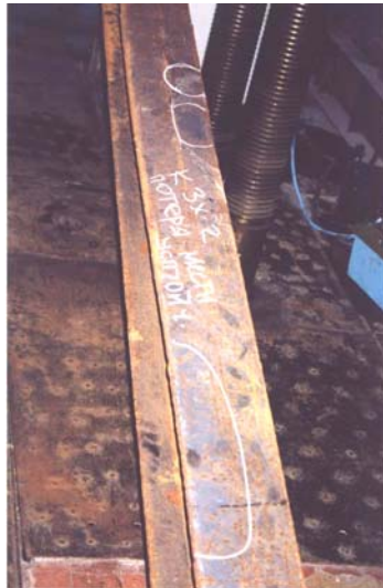
Рис. 2. Потеря местной устойчивости сжатого пояса образца с наплавленными валиками
