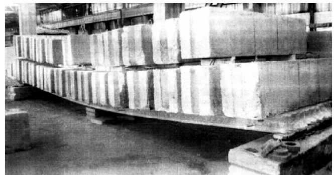
Рис. 4. Общий вид плиты при предельной вертикальной нагрузке
