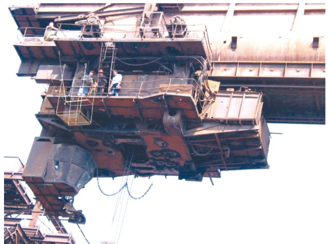
Рис. 2. Общий вид тележки рудно-грейферного крана-перегрузателя
