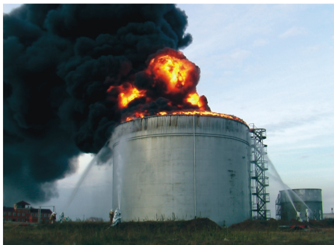
Рис. 7. Вогневі випробування гасіння пожежі на резервуарі PBC-5000
