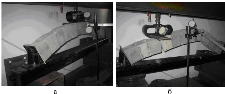
Рис. 1. Схемы загрузки модели: а – симметричная; б – несимметричная
