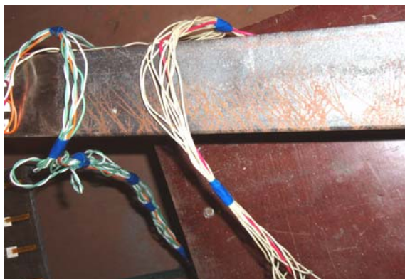
Рис. 1. Следы правки на полках швеллеров № 20у
