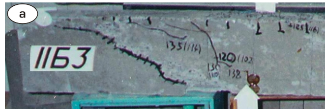
Рис. 4. Общий вид картины трещинообразования железобетонной конструкции ИБ3 первой серии
