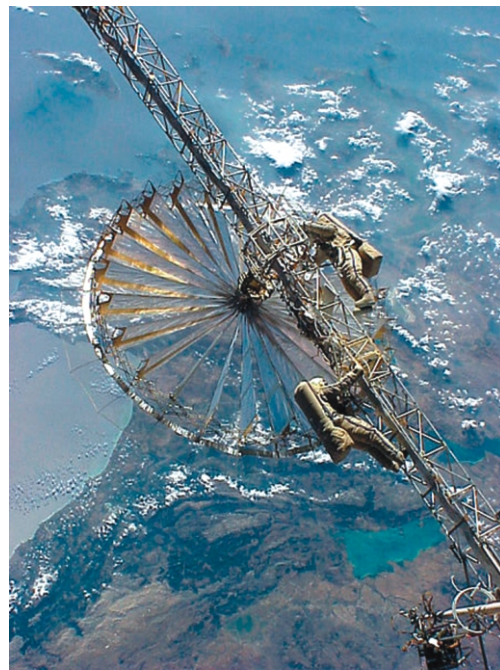
Развертывание антенны «Рефлектор»
