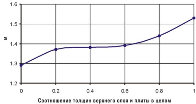
Рис. 1. Изменение упругой характеристики плиты  $l=f(\ell)$
