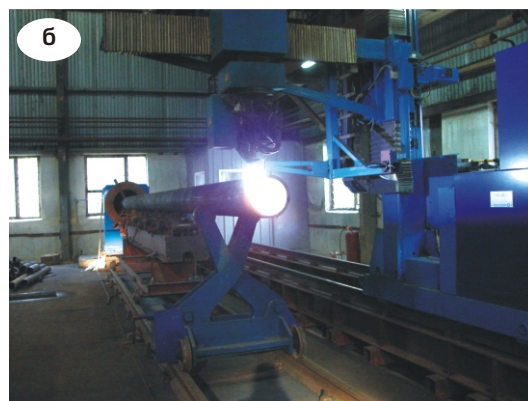
Рис. 2. Машина газокисневого і плазмового різання труб «TUBOSEC-1500»:
