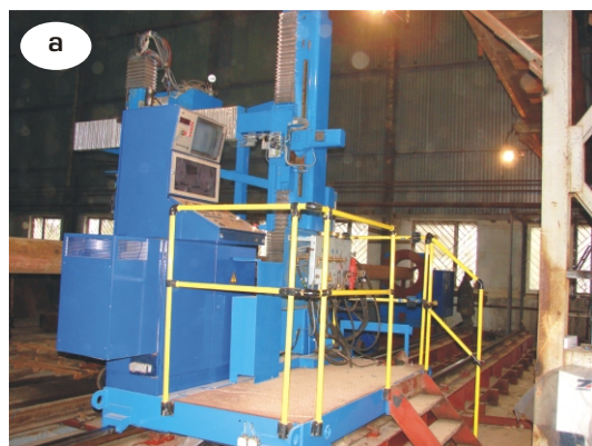
Рис. 2. Машина газокисневого і плазмового різання труб «TUBOSEC-1500»:
