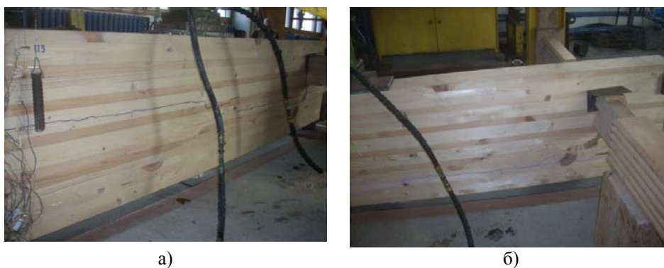
Рис. 6. Общий вид балок Б-1 (а) и Б-2 (б) после испытаний
