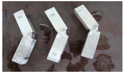
Рис. 14. Структурні стрижні типу «Novum». Зразки після тесту на ударну в'язкість
