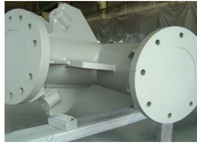
Рис. 13. Патрубки з різью під структуру. Фланці для стиків стрижнів ферми
