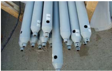
Рис. 14. Структурні стрижні типу «Novum». Зразки після тесту на ударну в'язкість
