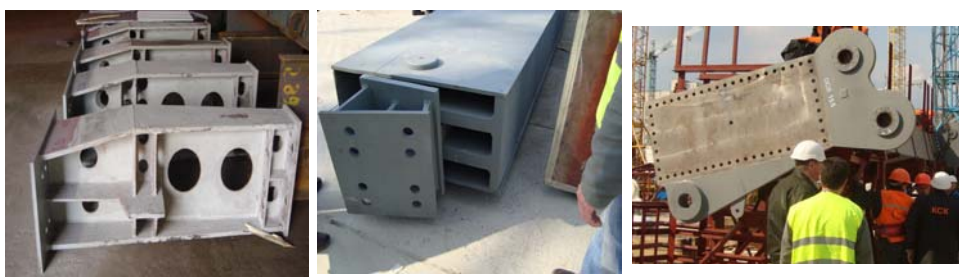
Рис. 7. Закладні деталі. Опорний вузол колони. Торець ригеля UCR
