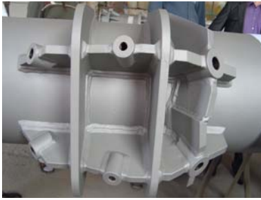
Рис. 13. Патрубки з різью під структуру. Фланці для стиків стрижнів ферми
